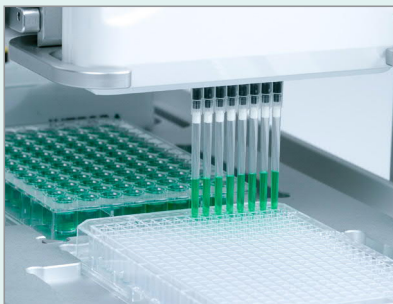
Transfert de plaques 24 – 48 – 96 – 384 puits
